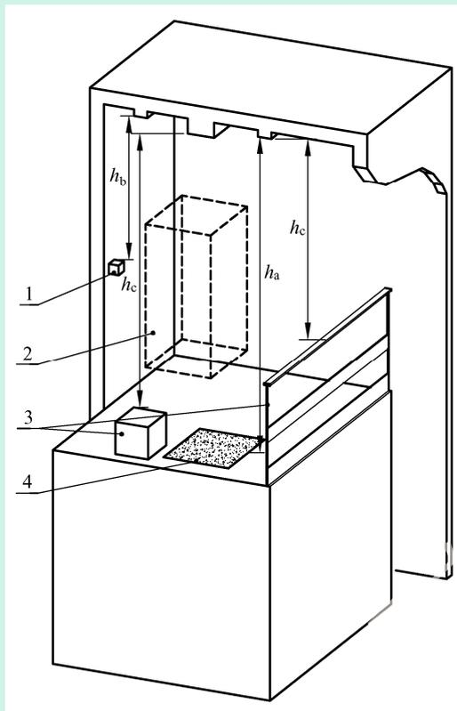
1——导靴或者滚轮、悬挂装置端接装置、垂直滑动门的横梁或者部件以及液压驱动电梯上行柱塞顶部组件的最高部件；
