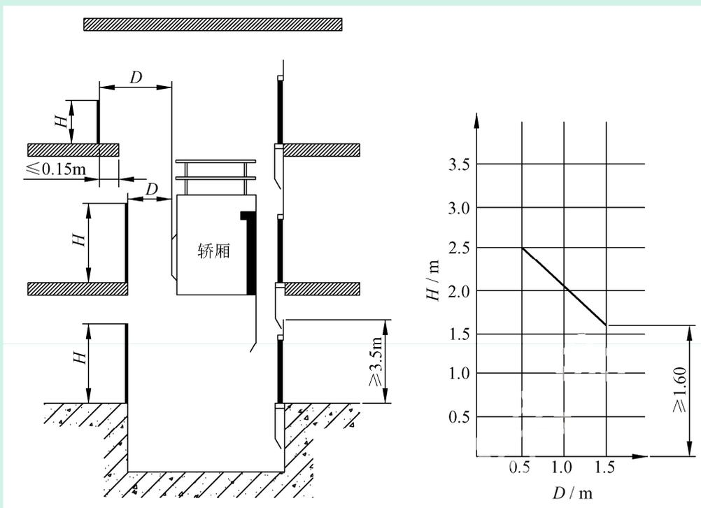
$H$ ——围壁高度(对于斜行电梯,指垂直测量值),单位为米(m);
